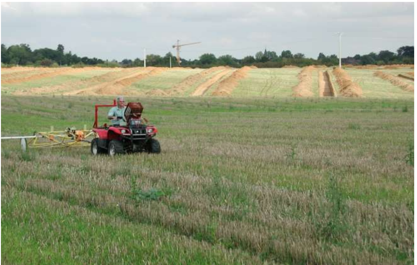
Fig.6 : Mesure géophysique en continu (EM31 Geonics) sur le projet d'aménagement de Vémars (Val d'Oise). En arrière-plan des tranchées mécaniques de diagnostic. Geocarta©
